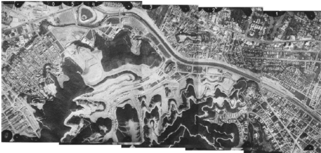
Figura 3. Modificaciones topográficas en las colinas del sur del valle de Caracas para la implantación de la urbanización Colinas de Bello Monte, correspondiente al año 1953. Fuente: Modificado de fotografías aéreas de 1953.
